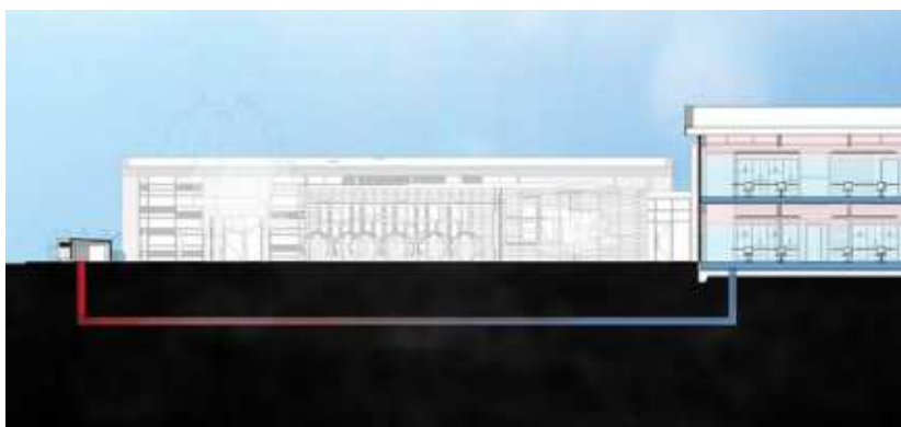
Figura 87: Sistema Condicionamento de Ar Passivo
