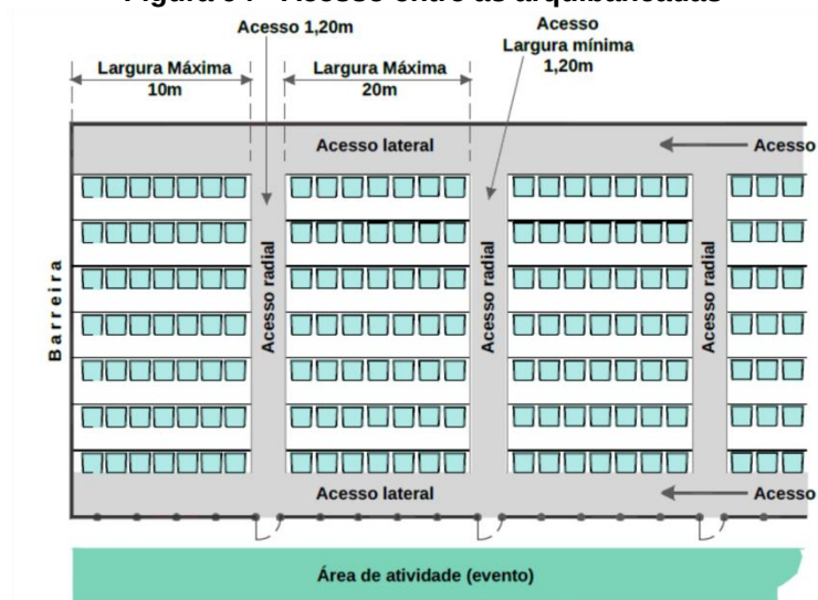
Figura 94 - Acesso entre as arquibancadas
