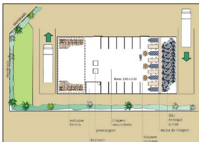
Figura 70 – Organização do setor de triagem – Planta Baixa Fonte: MINISTÉRIO DAS CIDADES, 2008
