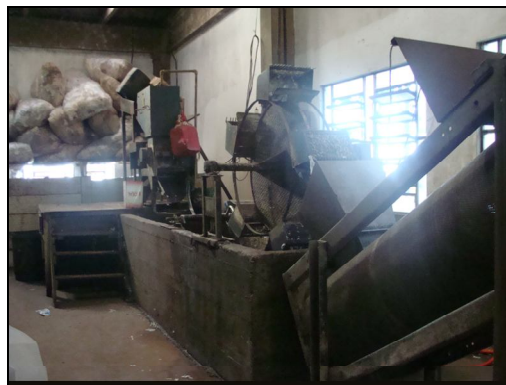
Figura 26 – Moinho e tanque lavador Fonte: Autora, 2009
