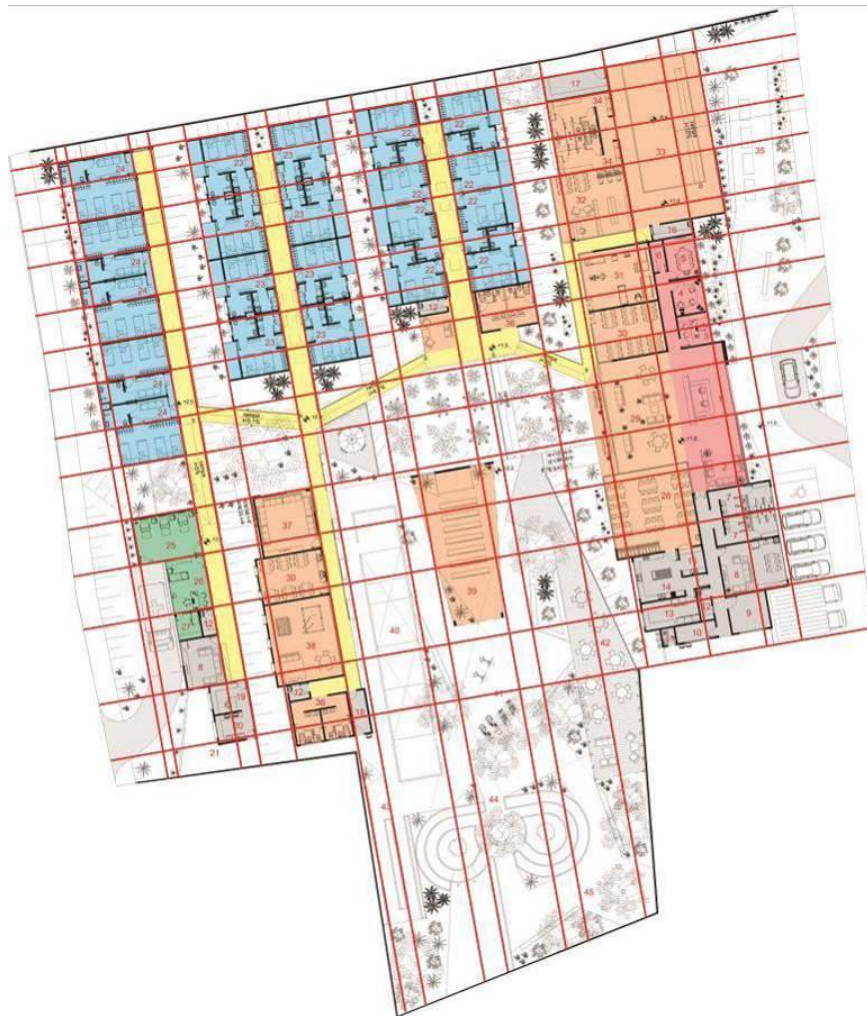
Figura 42 – Análise malha estrutural
