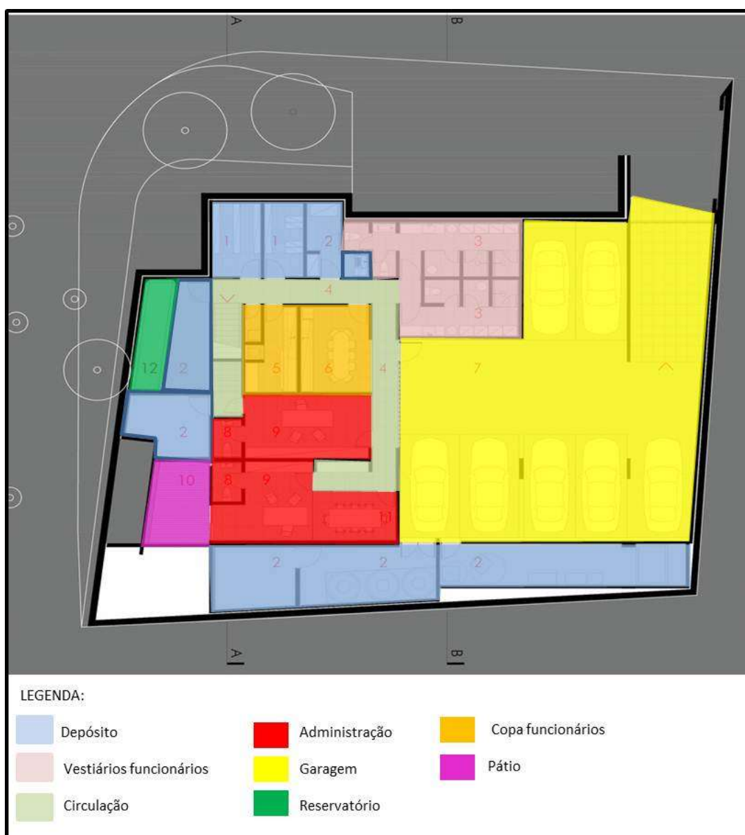
Figura 47 – Planta baixa pavimento subsolo.
