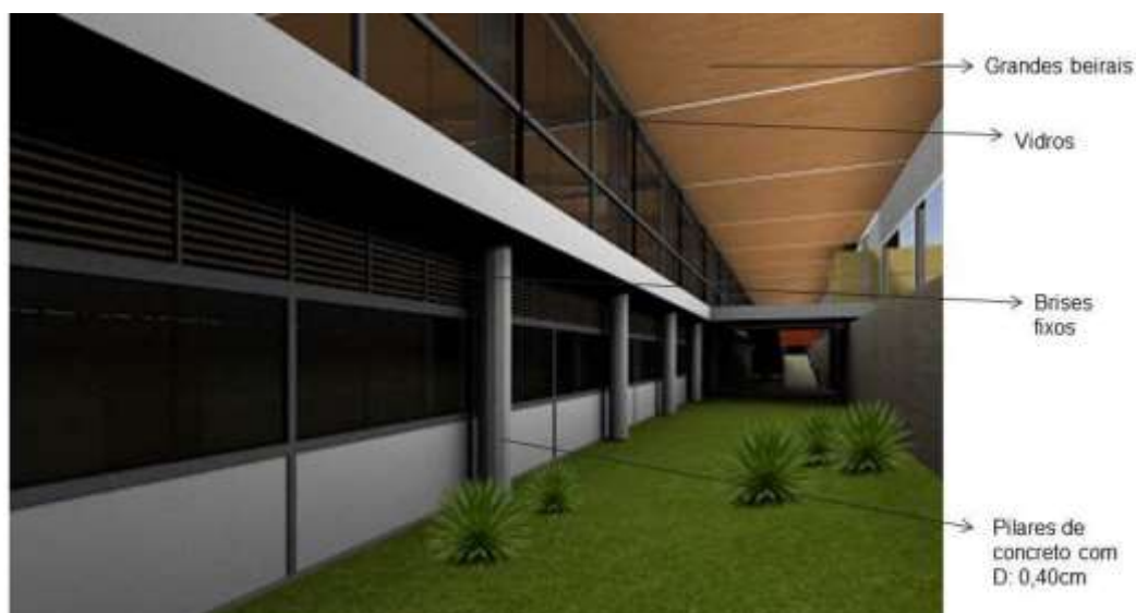
Figura 36 – Brises e janelas
