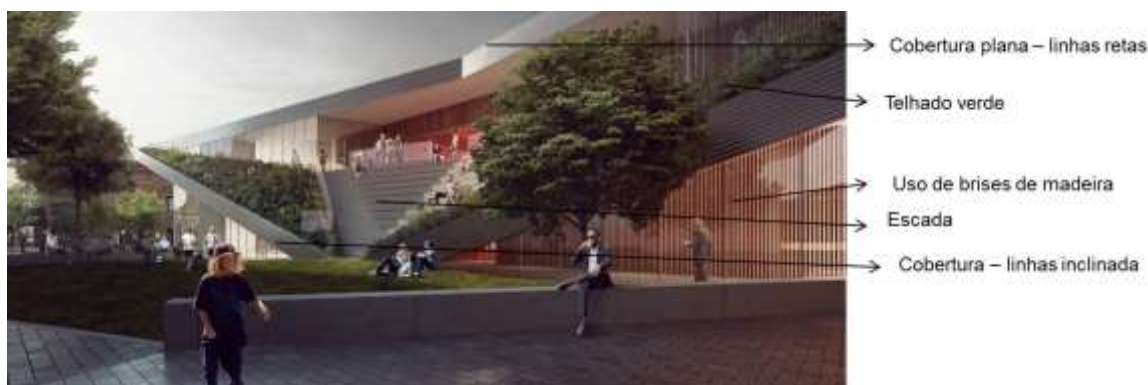
Figura 56 – Vista da parte da escada
