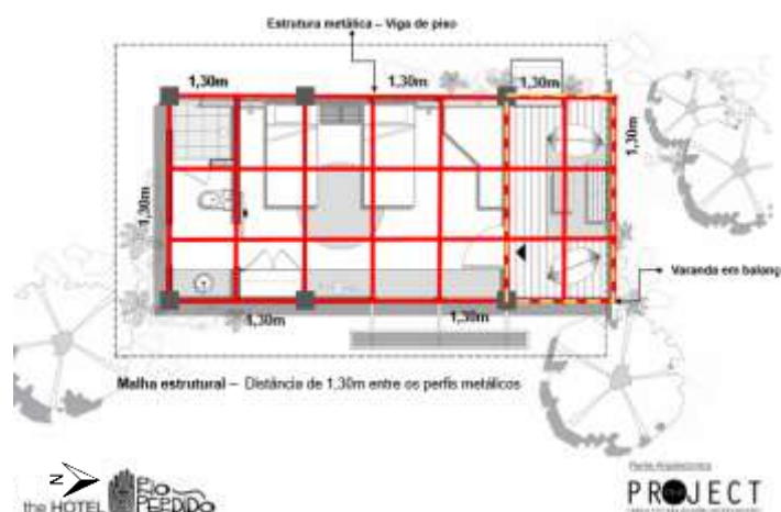
Figura 82 – Malha estrutural dos Bangalôs
