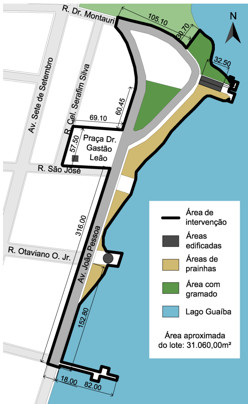
Figura 21 - Levantamento planialtimétrico do lote
