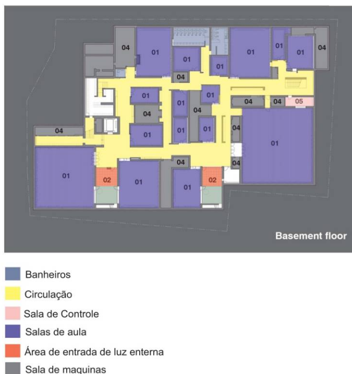
Figura 42- Planta Baixa pavimento Subsolo.
