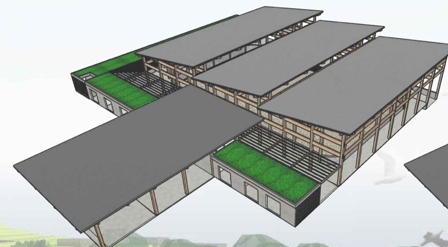
COBERTURA DE CONCRETO PLANA, COBERTURA VERDE, PERGOLADO COM VIDRO LAMINADO E TELHA SANDUÍCHE
