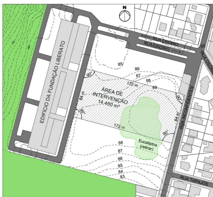
Figura 42 – Área de intervenção com dimensões e curvas de nível.
