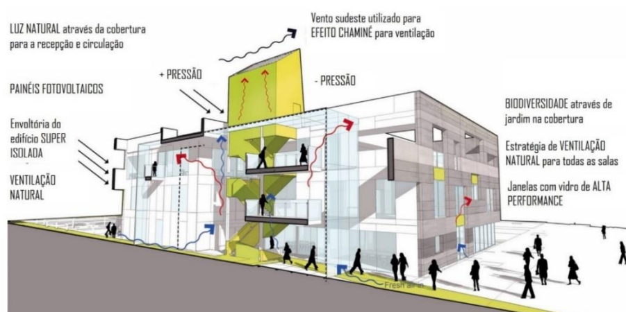
Figura 61 – Esquema das soluções climáticas do projeto.
