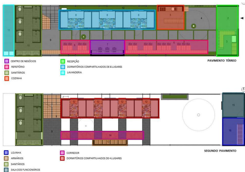
Imagem 61: Planta Baixa Térreo e Segundo Pavimento
