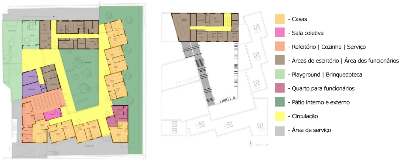
Figura 21: Planta baixa térrea e superior da casa-abrigo.
