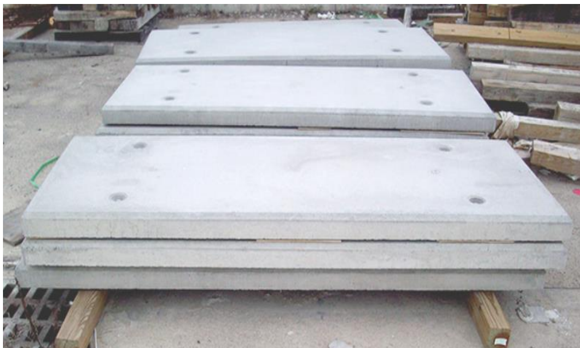
Figura 54 – Painéis de concreto pré-moldado.
