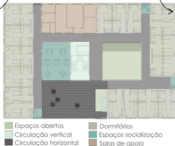
**FIGURA 52: PLANTA BAIXA 2º PAVIMENTO**
