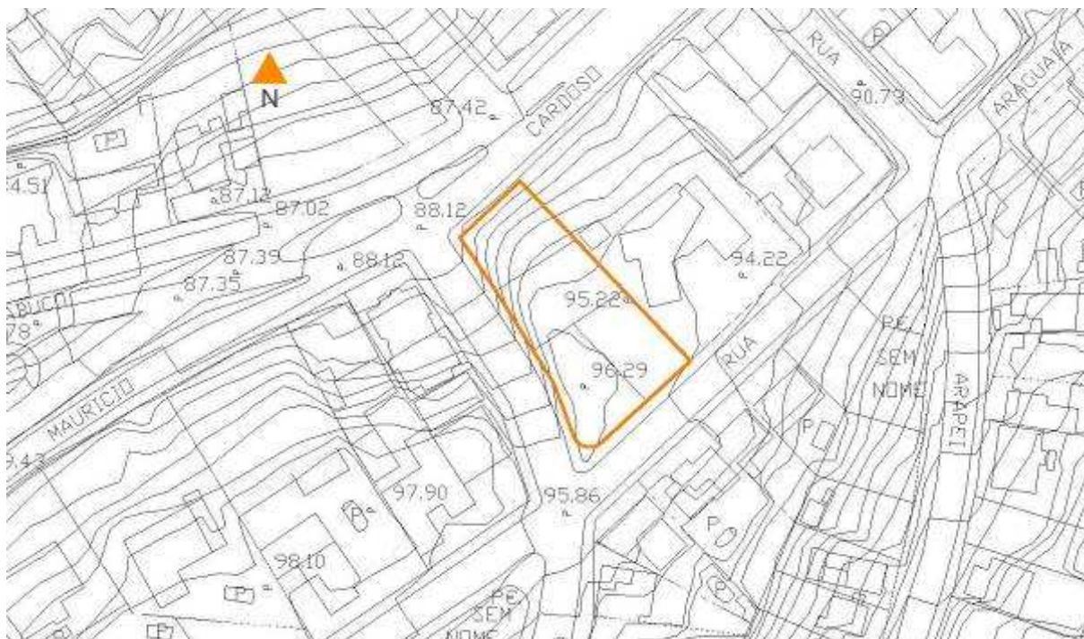
Figura 3 – Desenho do lote, com curvas de nível. Fonte: Prefeitura Municipal de Novo Hamburgo, 2008.
