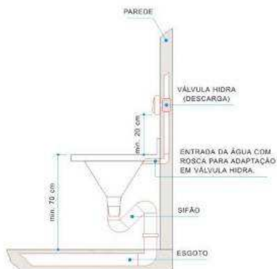
Imagem 35 – Lavatório Especial para Expurgo e Figura 10 – Esquema de Instalação de Expurgo Fonte: HIDRONOX, 2010.
