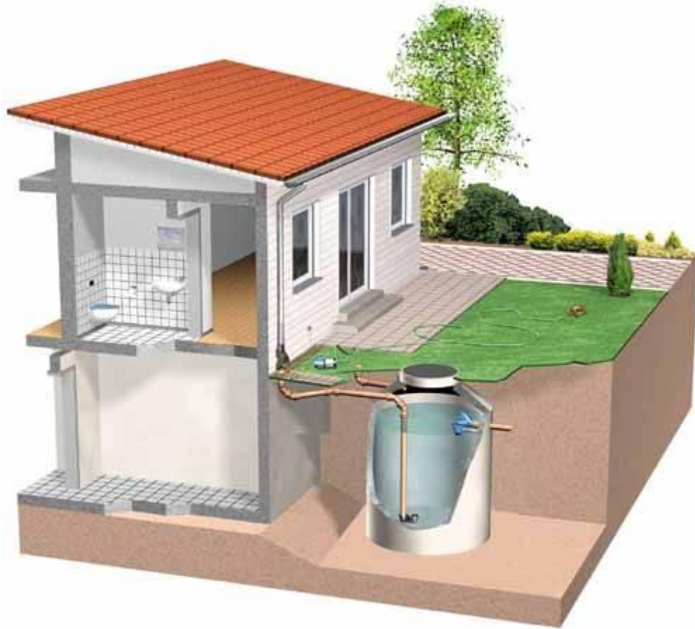
Figura 08 - Modelo de sistema padrão para recolhimento e reuso da água da chuva. (Fonte: GOOGLE IMAGES, 2010)
