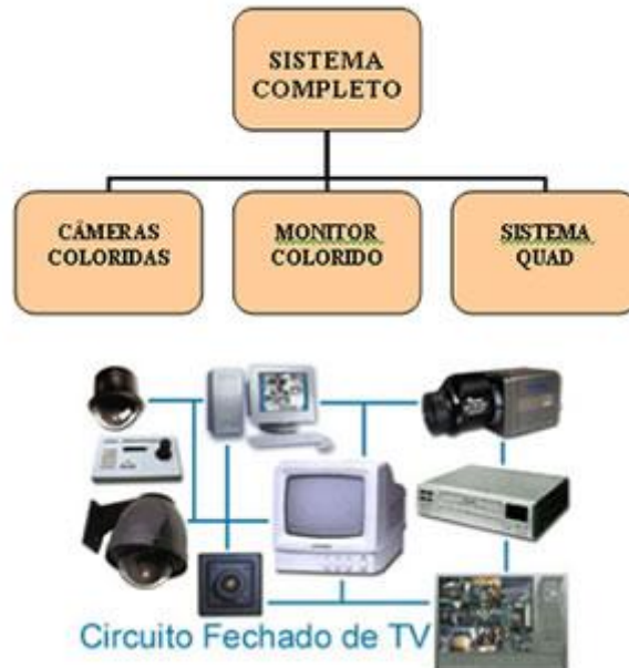
Figura 12 - Esquema para Circuito Fechado de Televisão (CFTV).
