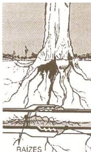
**Figura 52: Interferência das raízes na infraestrutura subterrânea**
