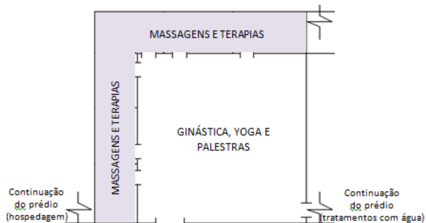
Imagem 14 – Planta baixa esquemática parcial do prédio novo, sem escala, mostrando a relação das salas de massagens e terapias com a grande sala de ginástica. Fonte: autora (2011)
