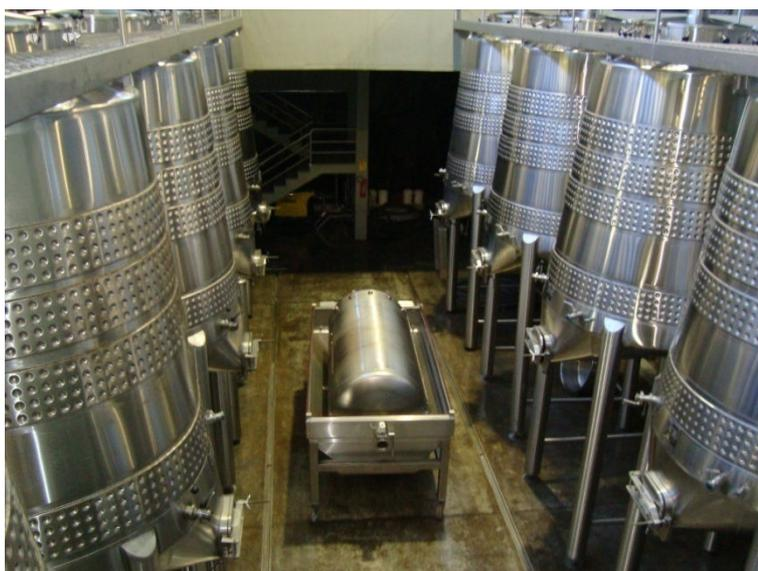
Imagem 11. Tanques de fermentação e prensa horizontal, vinícola Luiz Argenta (AUTOR, 2012)
