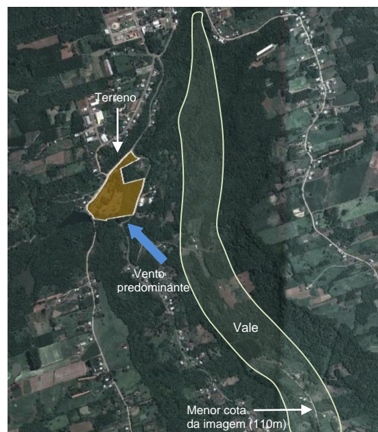
Imagem 17 – Análise do vento predominante com vista mais próxima ao terreno. (Fonte: Google Earth, tratada digitalmente pela autora).
