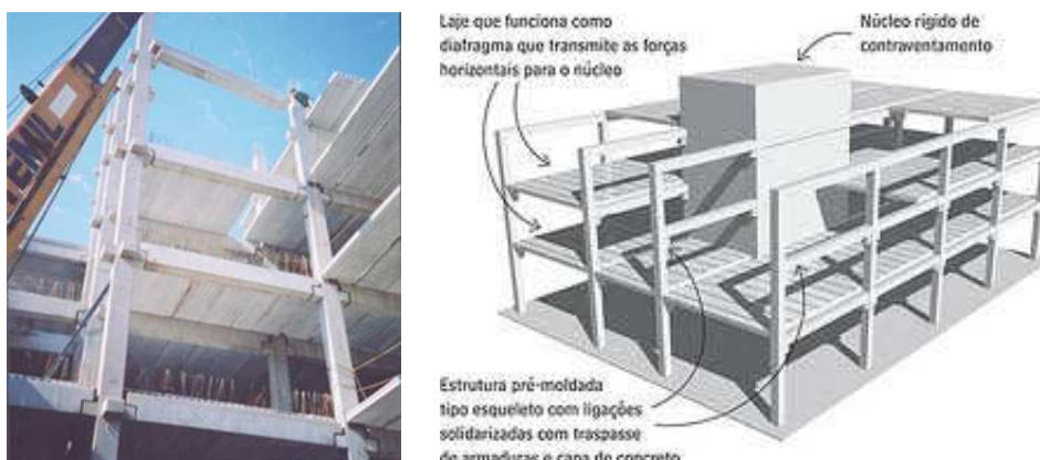
Imagens 125 e 126: Sistema estrutural de concreto pré-moldado. Fonte: VTN, 2012.
