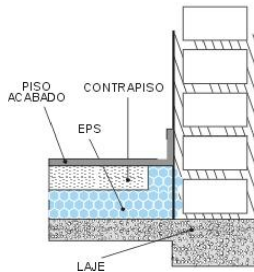
Figura 16 - isolamento acústico entre lajes Fonte: ABRAPEX,2011
