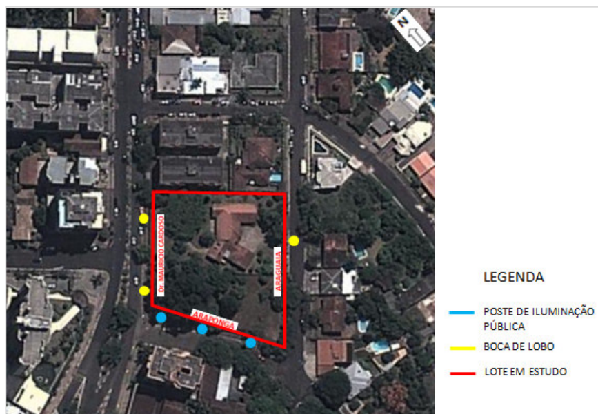
Imagem 28 – Levantamento da infraestrutura do lote. Fonte: Autora, (2012).
