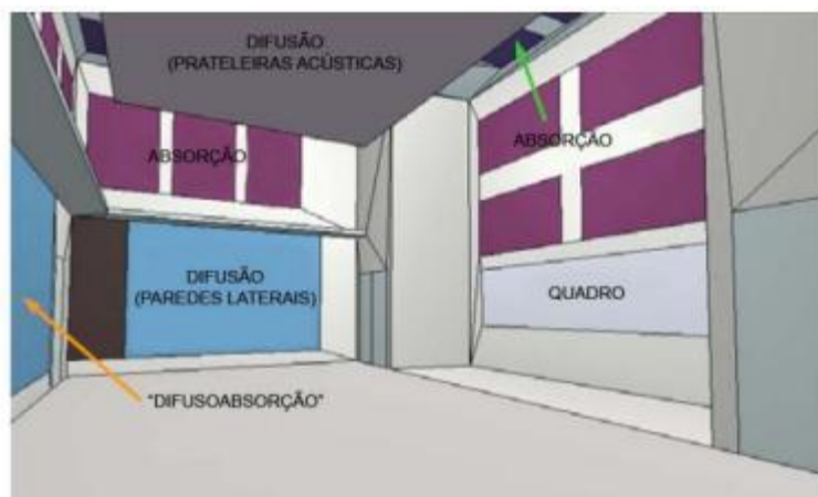
Figura 02 – Características dos materiais de revestimento de uma sala de ensaio musical.
