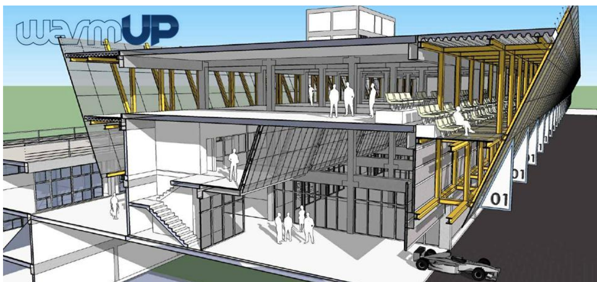
Figura 52 – Corte perspectivado da nova área dos boxes
