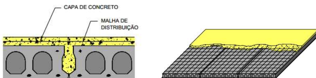
Figura 79 – Painéis solidarizados com capa de concreto e malha de distribuição
