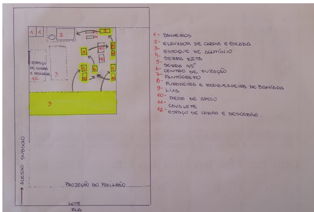
Figura 04 – Processo fabril do alumínio
