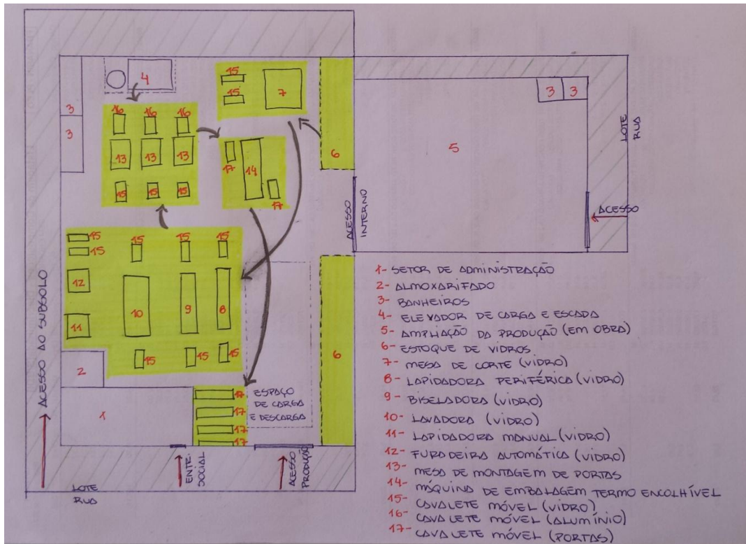
Figura 03 – Processo fabril do vidro
