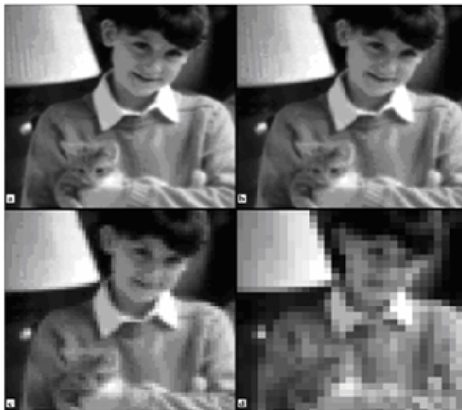
Figura 1.2 – Imagem digital (a, b, c e d) com diferentes números de pixels . Fonte – RUSS, 1999.
