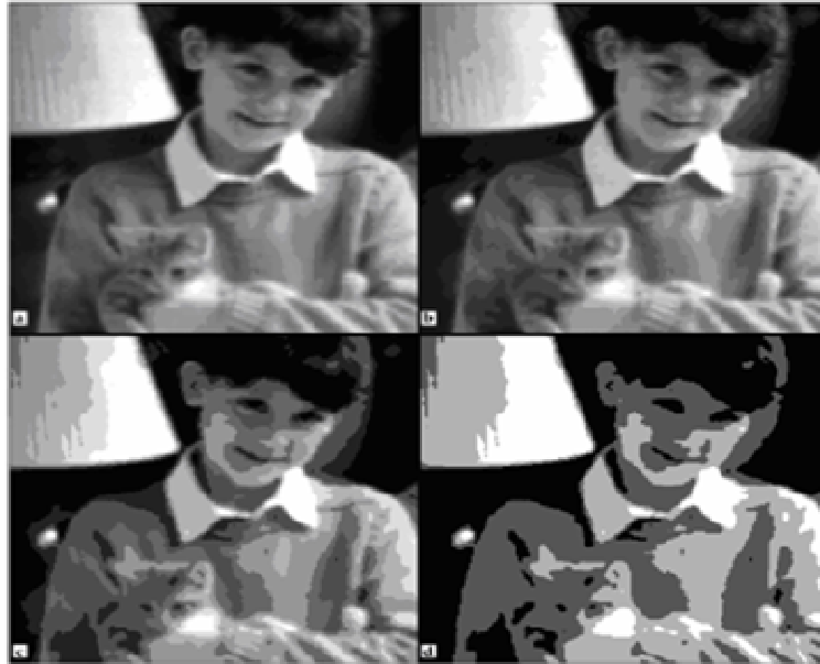
Figura 1.3 – Imagem (a, b, c e d) quantizada com diferentes níveis de cinza. Fonte – RUSS, 1999.
