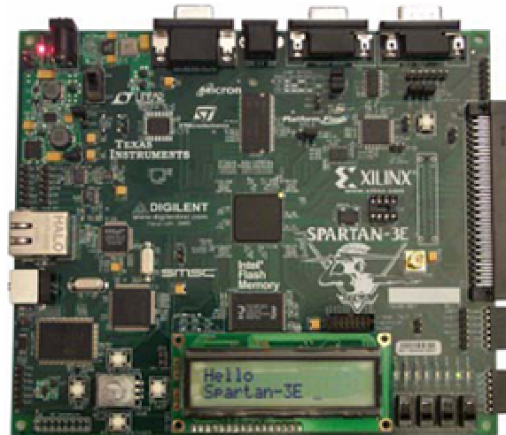
Figura 4.2 – Foto da Plataforma de Prototipação Spartan-3E Starter Kit. Fonte – XILINX, 2006a.
